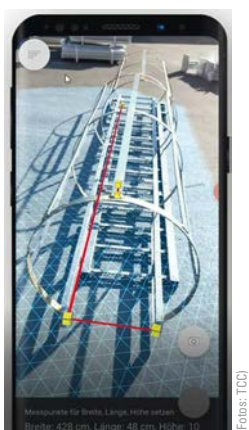
Bild 2 Die Abbildung zeigt den Bauteil-Vermessungsvorgang der Coatinc-App.
