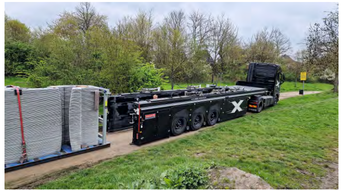
Bild 3 Der Transport der Einzelsegmente erfolgte mit einem geschlossenen Innenbordlader zum Einsatzort in Beckum.
