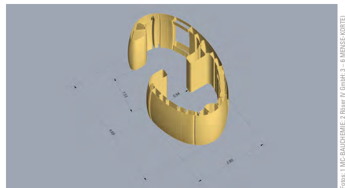
Bild 6 Bevor mit dem Druck des Minihauses begonnen werden konnte, wurde mithilfe einer Modellierungs-Software das Design entwickelt.
