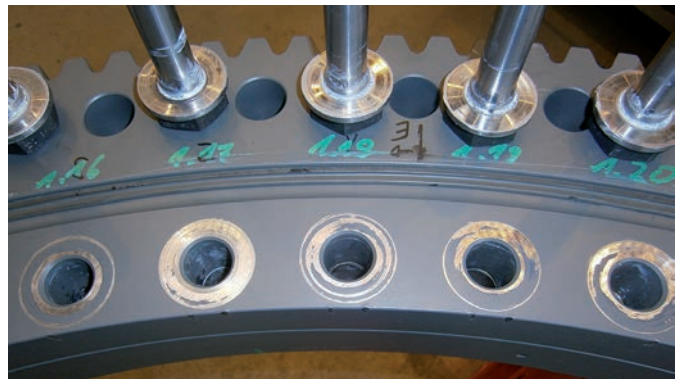
Bild 2. So nicht: Nur bei sachgemäßer Verschraubung und Wahl des richtigen Lackes ist der Korrosionsschutz gewährleistet.
