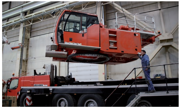
Bild 1. In nahezu jeder Branche werden lackierte Bauteile miteinander verschraubt – wie auch hier bei einem Mobilkran, wo der Oberwagen über den Drehkranz mit dem Unterwagen verbunden wird.
