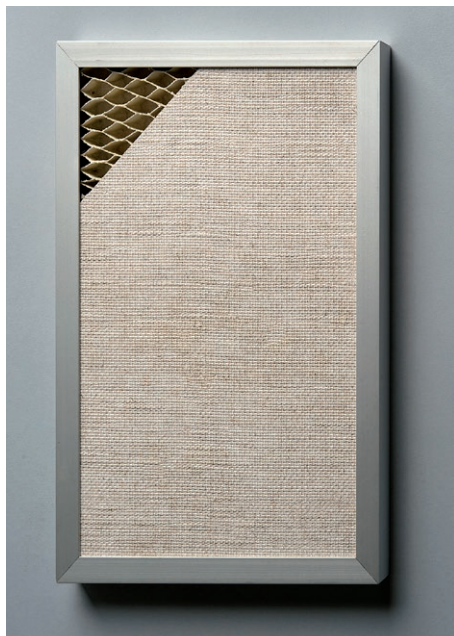
Abb. 1: Muster einer nichtbrennbaren Leichtbauverbundplatte aus düBraFa-Decklagen und Papierwaben-Mittellage (Foto HFM)
