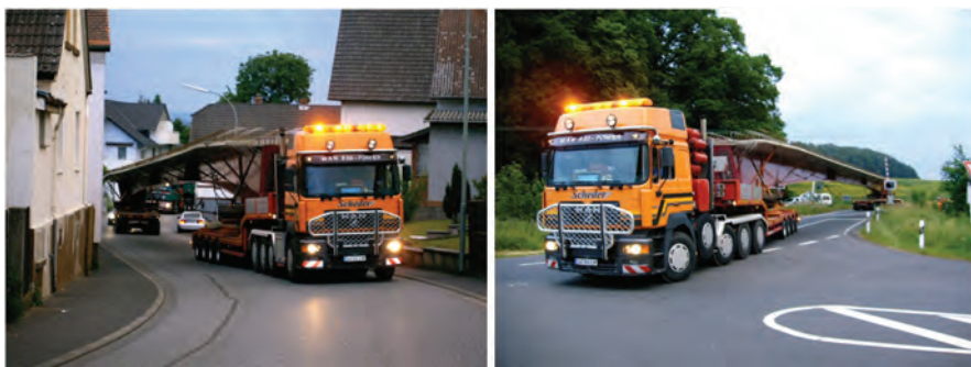
Abb. 2.15 Transport eines Brückenträgers.
