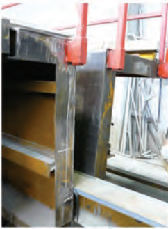
Abb. 2.10 Schalung einer TT-Platte.
