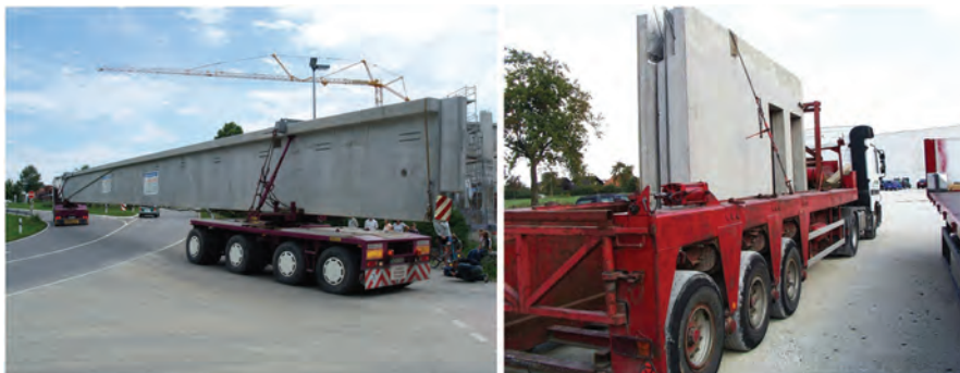
Abb. 2.14 a) Zugmaschine mit Nachläufer, b) Innenlader.
