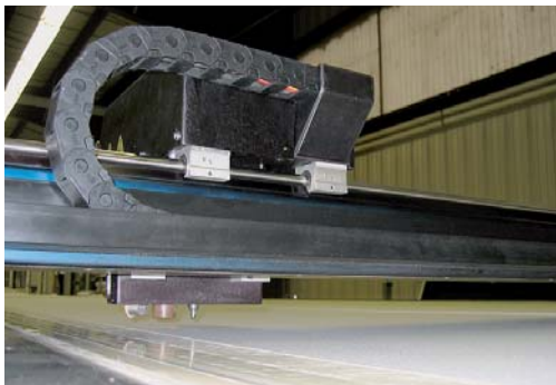
Abb. 108: links, mitte: Mechanische Zuschnideanlage mit Rundmesser; rechts: Stoßmesser-Handmaschine
