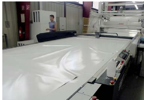
Abb. 108: links, mitte: Mechanische Zuschnideanlage mit Rundmesser; rechts: Stoßmesser-Handmaschine
