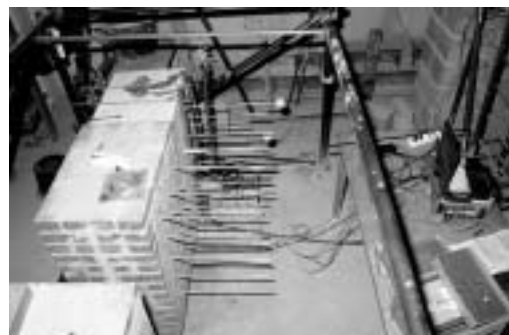
Bild 8. Ankerzugversuch im Labor: Ziegelmauerwerk aus Schleswiger Domziegel . Hinten ein Prüfkörper aus monolithischem Raumünzacher Granit. Hier werden jeweils drei Versuchsserien mit insgesamt 30 Verpressankern durchgeführt
