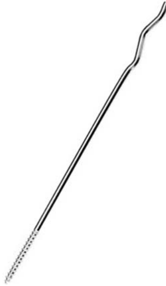
Bild 11. Einschraubanker für die Verblendung von Holzkonstruktionen für Schalenaufstände bis zu 155 mm (Fa. BEVER, Zul.-Nr. Z-17.1-924)
