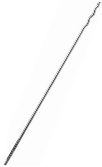
Bild 12. Dübelanker zur nachträglichen Verankerung der Verblendschale mit der tragenden Innenschale bestehend aus Beton oder Vollsteinen. Zugelassen für Schalenaufstände bis zu 200 mm (Fa. BEVER, Zul.-Nr. Z-21.2-1009 und Z-17.1-825)
