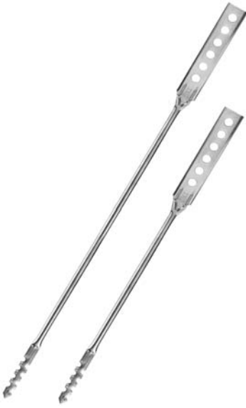
Bild 10. Bauaufsichtlich zugelassener Drahtanker für die Schalenaufstände bis zu 200 mm zum Einlegen in die Lagerfuge bei Verwendung von Dünnbettmörtel für die tragende Innenschale (Fa. BEVER, Zul.-Nr. Z-17.1-888)
