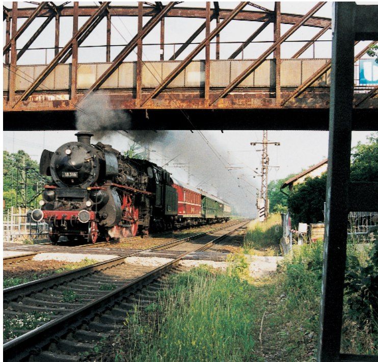
Die Holzbrücke in Mannheim-Friedrichsfeld, eröffnet am 8. 4. 1903, bemessen für eine Dampfwalze von 23 t, kurz vor dem Abbruch im Jahr 1999; darunter eine „Badische IV h“, eine 4-Zylinder-Dampflokomotive Baujahr 1919, vor einem historischen Sonderzug auf der Fahrt von Mannheim nach Heidelberg.
