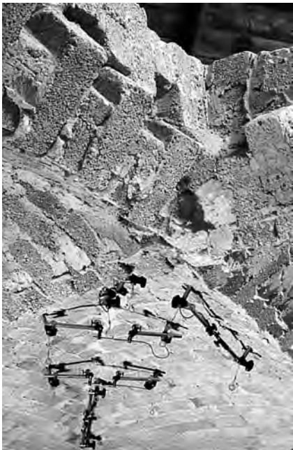
Bild 8. Aufbau (oben, rechts) und Lage (links und unten, rechts) der digitalen Wegaufnehmer im Gewölbe
