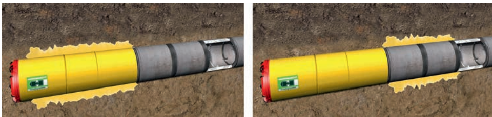
Bild 7-34 Verlegung des Bereichs der Erstverpressung: Links normale Erstverpressung, rechts Bereich der Erstverpressung bei starker Verrollungsgefahr am Schild (Quelle: Herrenknecht AG)
