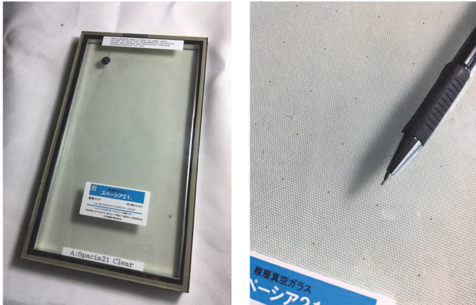
Bild 2-3 Vakuum-Isolierglas aus Japan mit den typischen Mikro-Abstandhaltern – hier als Innenscheibe eines konventionellen Isolierglases (NSG Japan), [2].
