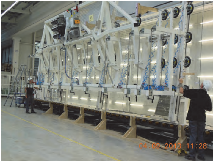
Bild 2-1 Verbund-Sicherheitsglas der Fa. Sedak GmbH mit Abmessungen 3,25 m x 10 m, 2013.
