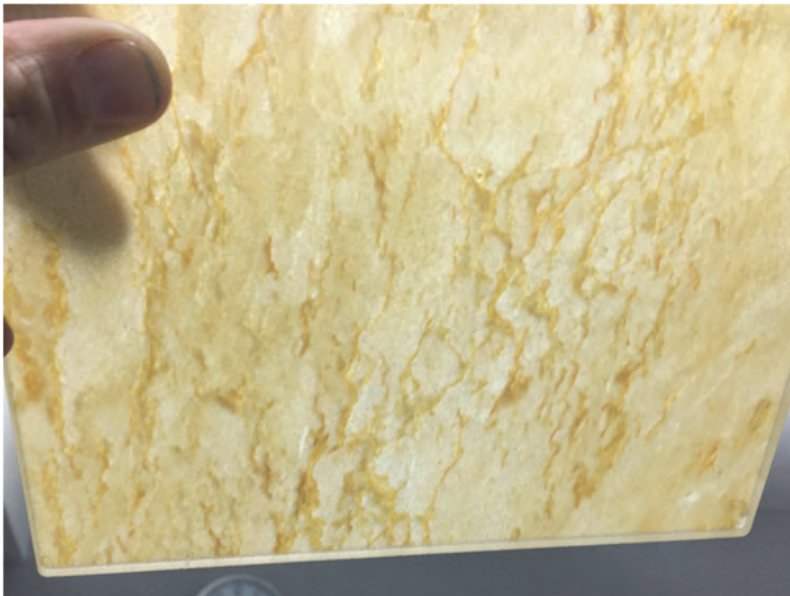
Bild 2-8 Transluzentes Glaslaminat in Kombination mit sehr dünnem Stein (Jogerst Steintechnologie GmbH).
