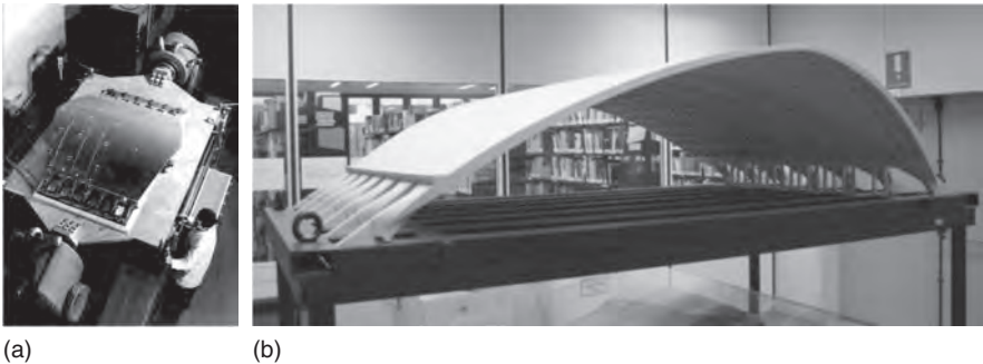
Figure 39.6 Model for the Leverone Field House, Hannover. (a) Model under test in 1971. (Image ISMES). (b) Model now located at the Dipartimento architettura rilievo disegno urbanistica storia at Università Politecnica delle Marche , in Ancona. (Image: Gabriele Neri)
