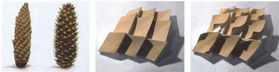
Bild 5-11 Bi-Wood Aktuatoren, a) Naturvorbild Zapfen feucht bzw. trocken, b) Holzschindel, c) Holzschindel [1].
