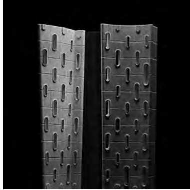
Bild 1. Entwurf einer 3D-gedruckten Ziegelwand (de Witte/Wilfinger)
