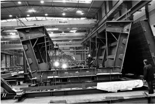
Bild 7. Zusammenbauvorrichtung Werkstatt (© 2016 Donges SteelTec GmbH)
