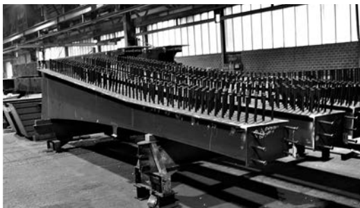
Bild 5. Kragarme 6 m (© 2016 Donges SteelTec GmbH)
