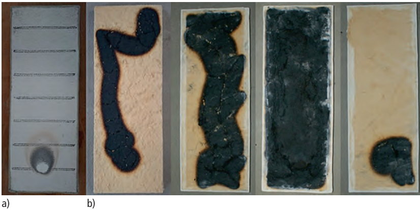
Bild 6. a) Vorderseite eines verputzten Probekörpers nach der Beflammung sowie b) vier typische Schwelverläufe nach Versuchsende in Holzfaserdämmstoffmitte
