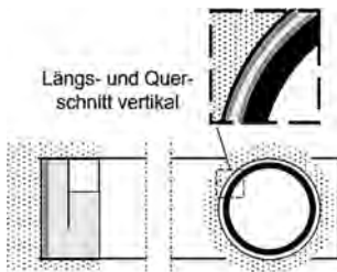
Bild 1. Flüssigkeitsstützung beim Tunnelbau und beim Rohrvortrieb [4]
