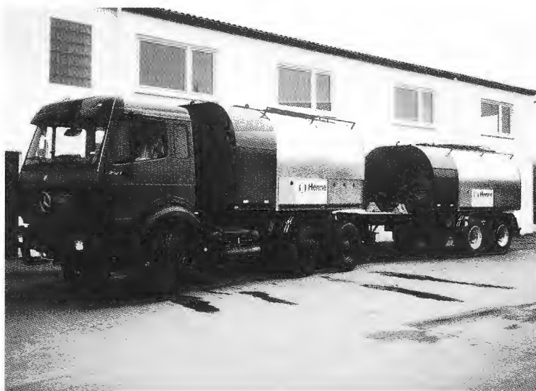
Bild H14 Gussasphalt-Kocher mit liegender Rührwerkswelle
