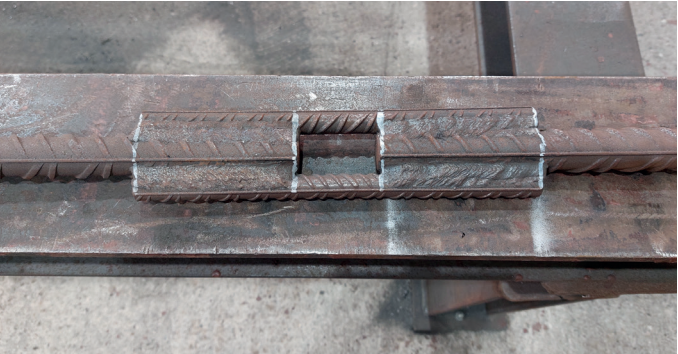
Bild 13: Beispiel für einen geschweißten Laschenstoß
