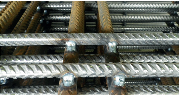
Bild 15: Beispiel für einen manuell geschweißten Kreuzungsstoß
