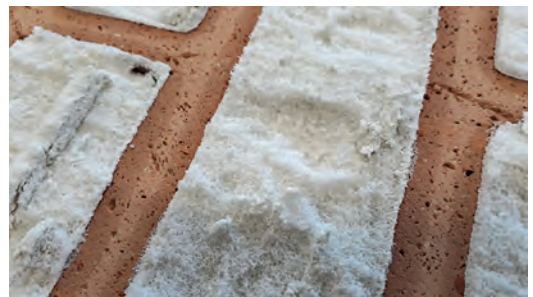
Bild 1. Sichtbare Wassermigration innerhalb eines Hochlochziegels (Foto: IAB)
