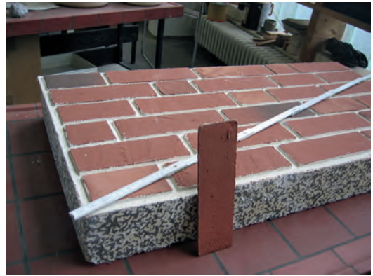
Bild 2. Dämmplatte mit aufgeklebten Klinker-Riemchen (Foto: Gigla)
