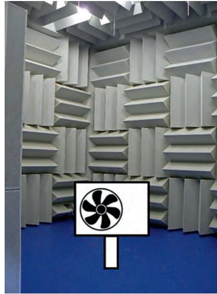
Bild 2. Bestimmung der Luftschalleistung einer GTA nach DIN EN ISO 3744 im Halbfreiefeldraum
