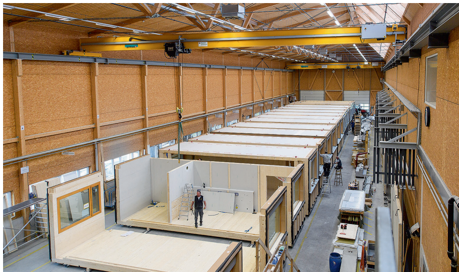
Bild 4 112 Raummodule wurden zusammen mit den Elementbauteilen in Großenlüder bei Fulda vorgefertigt und zur Montage just-in-time auf die Baustelle geliefert (Symbolbild Werk Blumer Lehmann)
