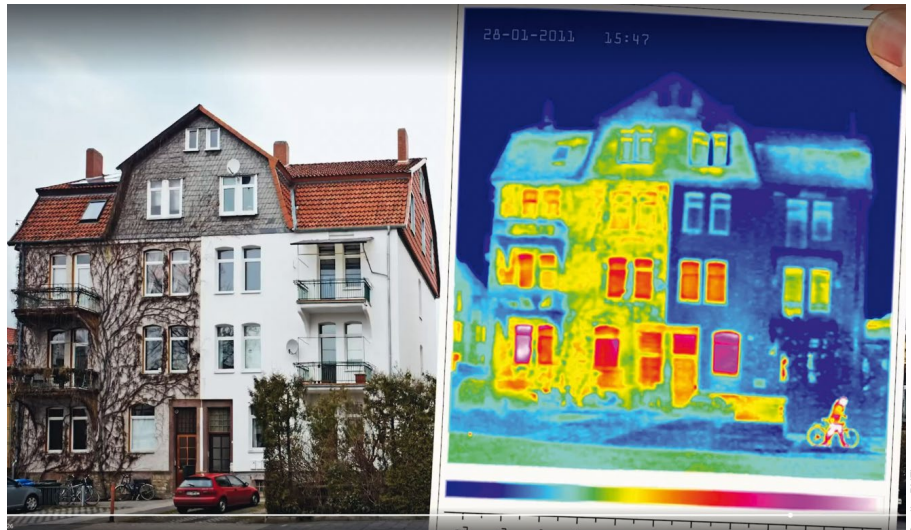
Bild 2 Komplexe Zusammenhänge werden visuell aufbereitet: Videostandbild aus der ersten Episode, mit dem der Zusammenhang von Fassadenbauteilen und Transmissionswärmeverlusten anschaulich gemacht wird
