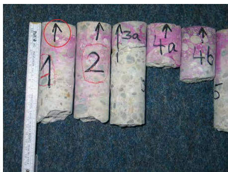
Bild 2 Bohrkern: Der nicht violett eingefärbte Teil des oberen Bohrkerns zeigt nach Aufsprühen der Phenolphthaleinlösung die vorhandene Karbonatisierung an. In diesen Bereichen ist der Korrosionsschutz der Bewehrung nicht mehr gewährleistet.
