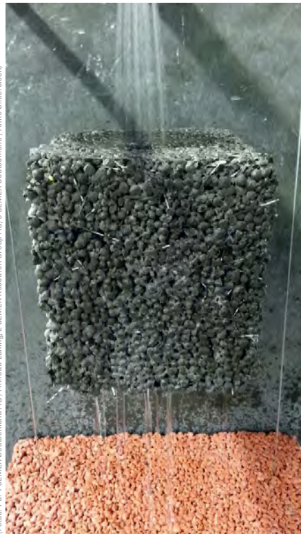
Bild 3 Nahaufnahme der offenporigen Oberfläche von Pervia Top®: Regenwasser kann durch die Schicht versickern, Aquaplaning wird vermieden.
