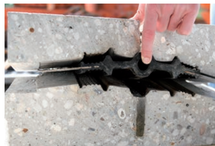
Bild 2 Das sind zwei der Betonprobekörper, die Felix Basler konstruiert und hergestellt hat. Er zeigt das schwarze Fugenband mit Stahl-laschen, hinter das ein Dichtmittel, nämlich Polyurethanharz, injiziert wurde.
