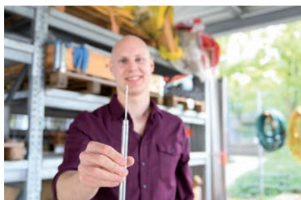
Bild 1 Sie sieht bedrohlich aus, ist aber nur für Betonkonstruktionen: Felix Basler zeigt eine Injektionsbohrnadel.
