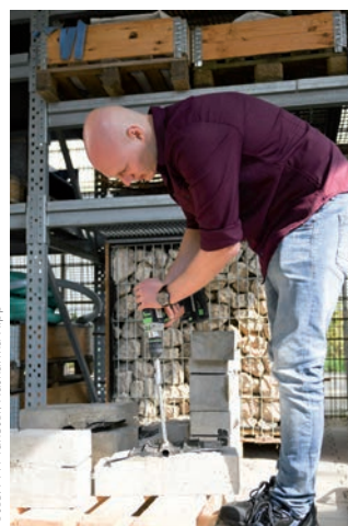
Bild 3 Mit einem Akkuschrauber bohrt Felix Basler die Nadeln in den Beton.
