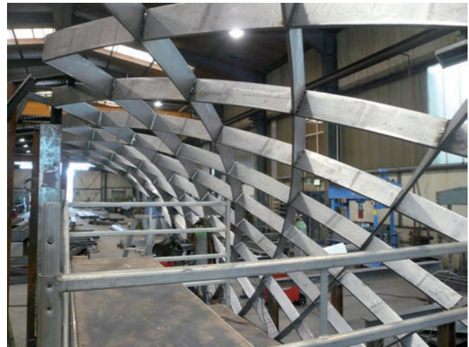
Bild 3 Fertigung: die Einzelstäbe 140 x 15 in S355 werden vor dem Verschweißen vortordiert
