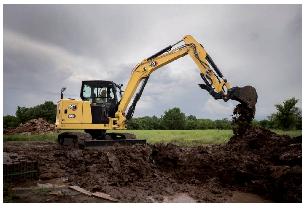
Bild 1 Der kompakte Cat Turbodieselmotor C2.4 entwickelt im neuen Minibagger 306 CR 42,3 kW ....
